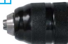
ESECUZIONE PROFESSIONALE per trapani elettrici e a batteria, con rotazione D+S e percussione. Chiusura rapida senza chiave con bloccaggio radiale, mediante rotazione del corpo mandrino. Corpo e parti operanti in acciaio, griffe in METALLO DURO per la massima prestazione di serraggio e durata.
